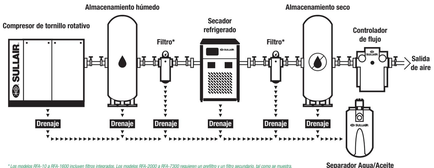
\* Los modelos RFA-10 a RFA-1600 incluyen filtros integrados. Los modelos RFA-2000 a RFA-7300 requieren un prefiltro y un filtro secundario, tal como se muestra.
